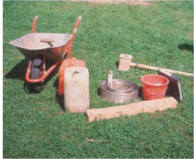
Messung der Versickerungsleistung mit Doppelring-Infiltrrometer
