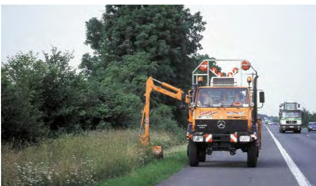
Einsatz Mäher mit Hydraulikschwenkarm bei straßenbegleitender Mulde
